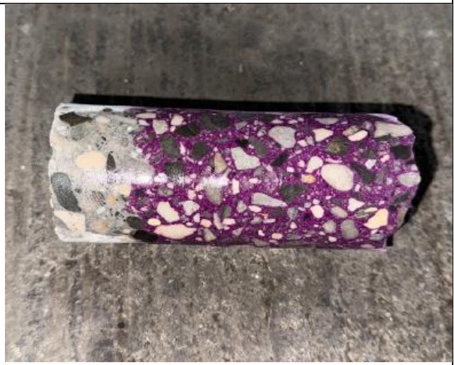
PRUEBA DE CARBONATACION SEGUNDA MUESTRA DE NUCLEO
