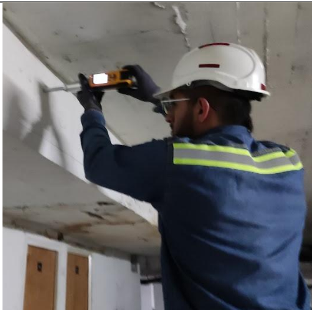
PRUEBA DE ESCLEROMETRIA V-S.N (NUCLEO 1)
