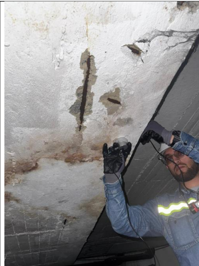
PRUEBA DE ULTRASONIDO EN V-A.F
